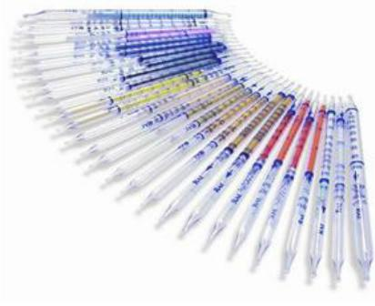
**Abbildung 5-5 Prüfröhrchen-Messtechnik**
